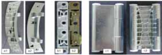
Şekil 16: Kalıpta yapılacak iyileştirmeler ile tüketilen hammadde miktarında azalma sağlanabilir.a) 1. Yeni dizayn (duvar kalınlığı 1,3mm), 2. Eksi dizayn (tüketilen zamak miktarından kazanç:%28,5.) b) 1. Yeni dizayn, 2. Eksi dizayn (tüketilen zamak miktarından kazanç:%11,6.) c) 1. Eski dizayn, 2. Yeni dizayn (tüketilen zamak miktarından kazanç:%30.)
